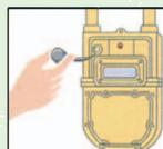
**2** メーターガス栓が開いていることを確認してください。復帰ボタンのキャップを左に回して外す。
