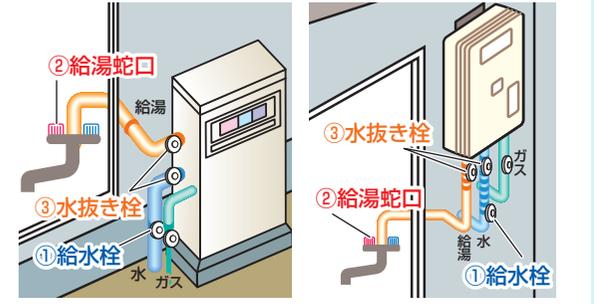
※水抜きした給湯器を次に使用するときには、水抜き方法の逆の順序で行う
